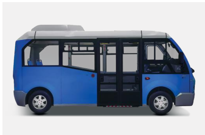
Porte passagers pivotant vers l'extérieur
