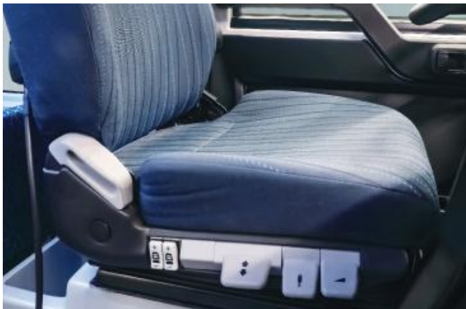
Asiento del conductor neumático ajustable en 8 posiciones, con reposabrazos
