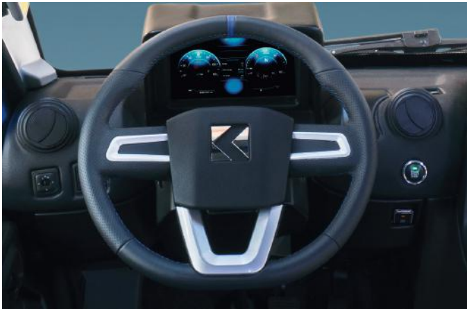
Höhen- & Neigungsverstellbares Elektrohydraulisches Lenkrad
