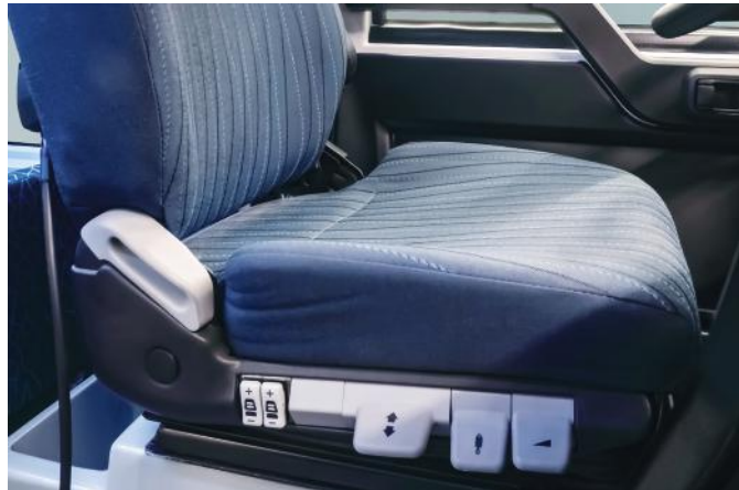
8- Fach Verstellbarer Pneumatischgefederter Fahrersitz
