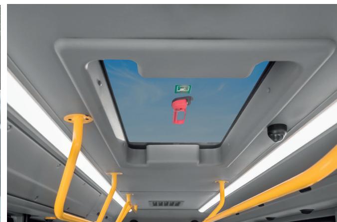
Botola elettrica sul tetto
