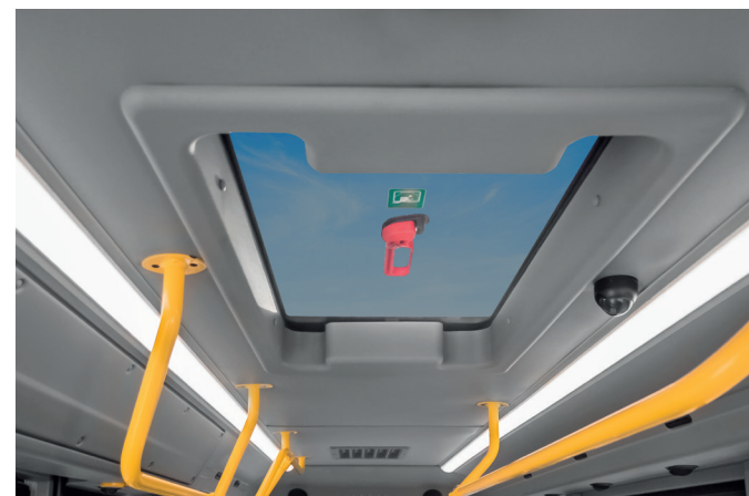
Trappe de toit électrique
