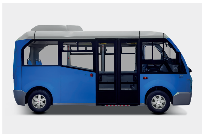
Porte passagers pivotant vers l'extérieur
