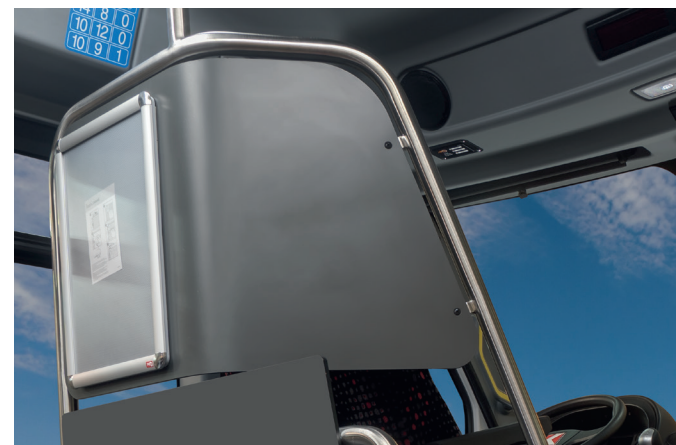
Cabine de conduite semi-fermée
