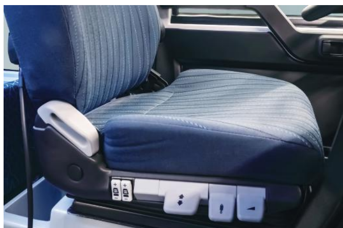
Siège pneumatique réglable 8 positions avec accoudoir
