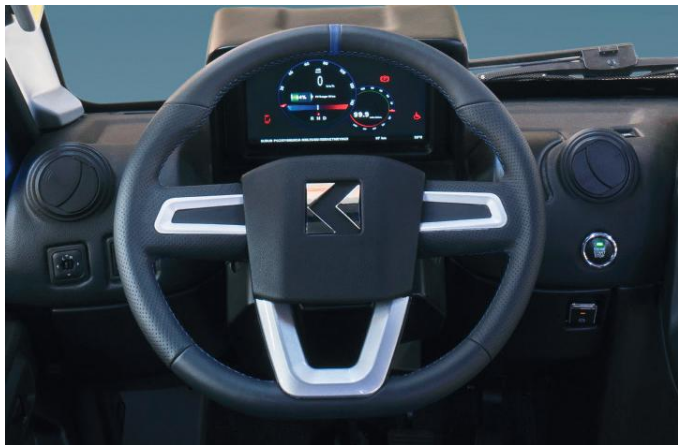
Volante de cuero electrohidráulico inclinable y telescópico
