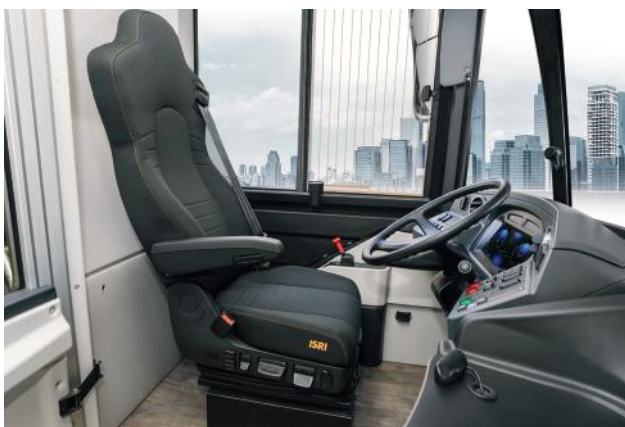
Sedile conducente pneumatico
