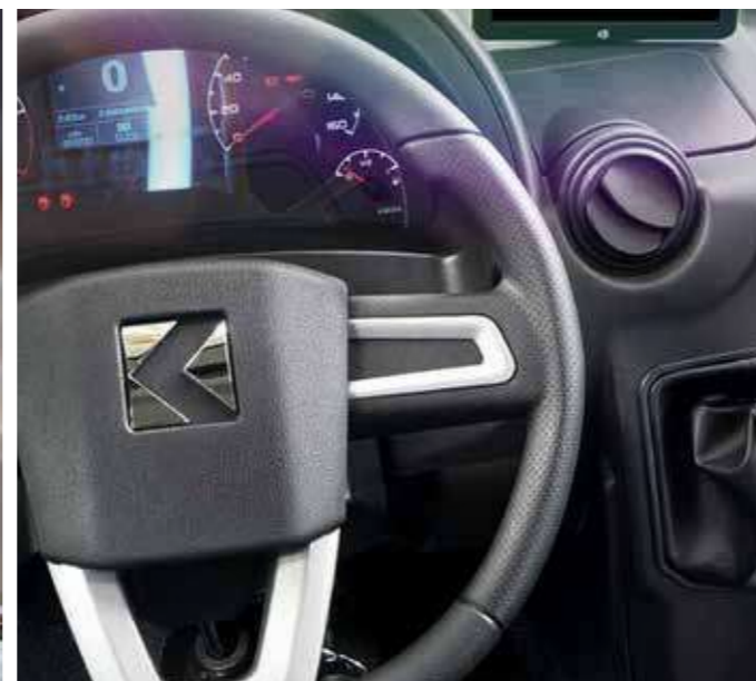
+ Elektrohydraulisches Teleskop- & Kipplenkrad
